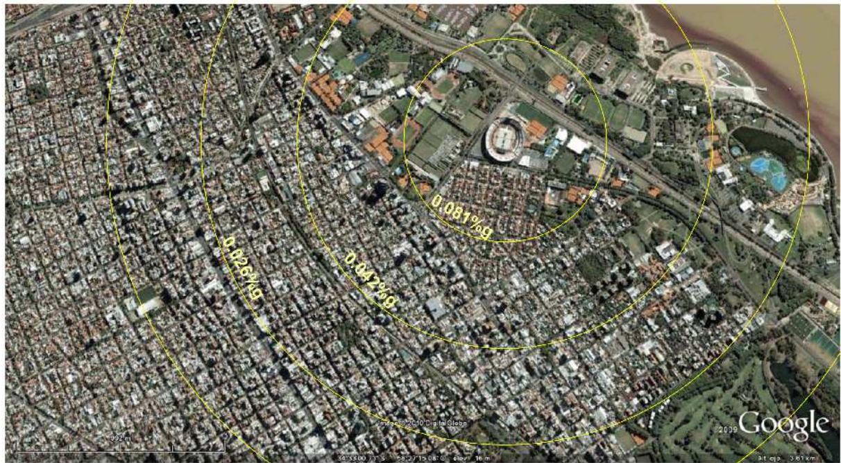
Fig. 7. Valor medio cuadrático de las aceleraciones horizontales en el suelo a 500, 1000 y 1500 m del estadio de River Plate
