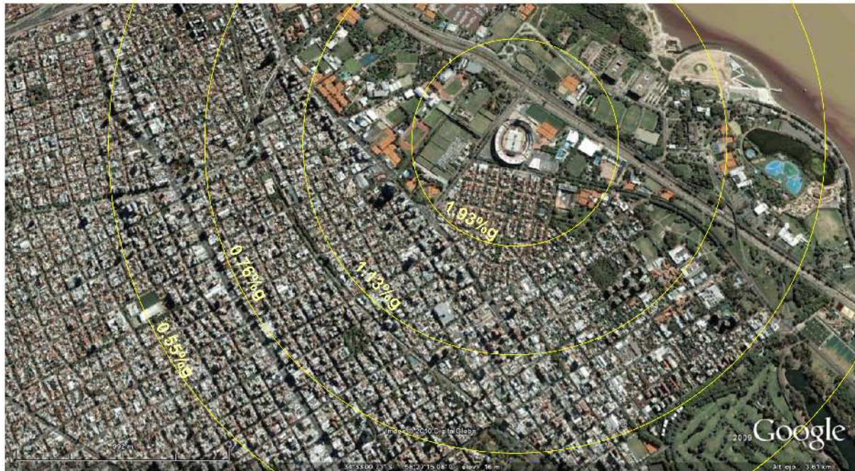
Fig. 10. Valor medio cuadrático de las aceleraciones horizontales en la azotea de edificios con frecuencia natural coincidente con el salto de los espectadores (2Hz) a 500, 1000, 1500 y 2000 m del estadio de River Plate
